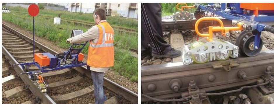
Рис. 1 Современный съемный двухниточный дефектоскоп АВИКОН-14
